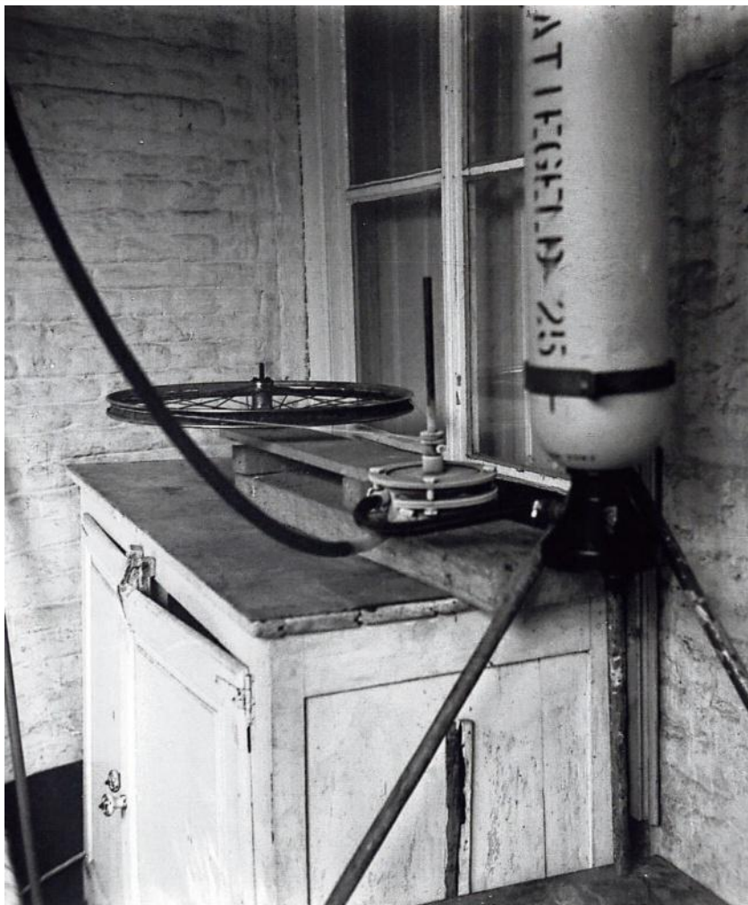
Boven: portret van Edmond Hustinx (1944) door Waalko Dingemans; onder: proefopstelling warmtepomp op binnenplaats van Hustinx’ woning.
